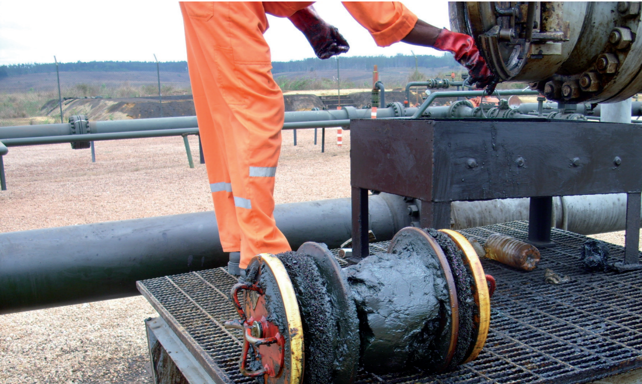
Pig après râclage d'une conduite
