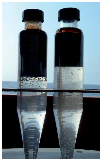
Résultat d'un bottle test réalisé sur site
