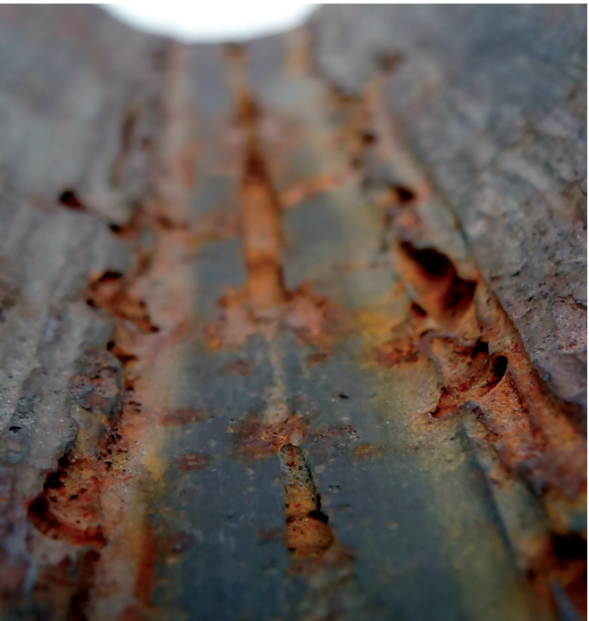
Coupe transversale d'une pièce en acier carbone avec divers types de corrosion visibles.
